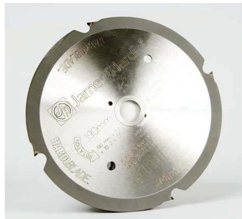
Les découpes intérieures aux lames sont réalisées avec **scie sauteuse**. Les lames employées sont à pointes rapportées carbure destinées au ciment composite. Un trou de 8mm minimum doit être percé aux angles intérieurs avant sciage, pour éviter la fissuration du panneau.
