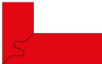
ASSEMBLAGE D'ANGLE FRAISE A PROFILER LEITZ
