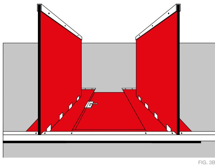
Les exemples de mise en oeuvre illustrent diverses possibilités de montages de cabines avec l'emploi d'accessoires variés. Il est recommandé d'utiliser des panneaux FunderMax Compact Interior de 13 mm d'épaisseur minimum.
