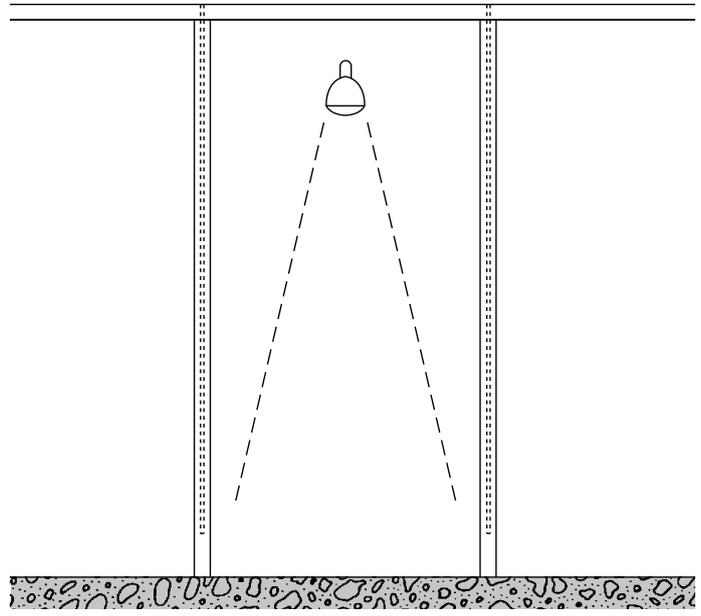
CLOISON DE SEPARATION DE DOUCHES AVEC MONTANTS D'APPUI LINTEAU EN TUBE PROFILE
