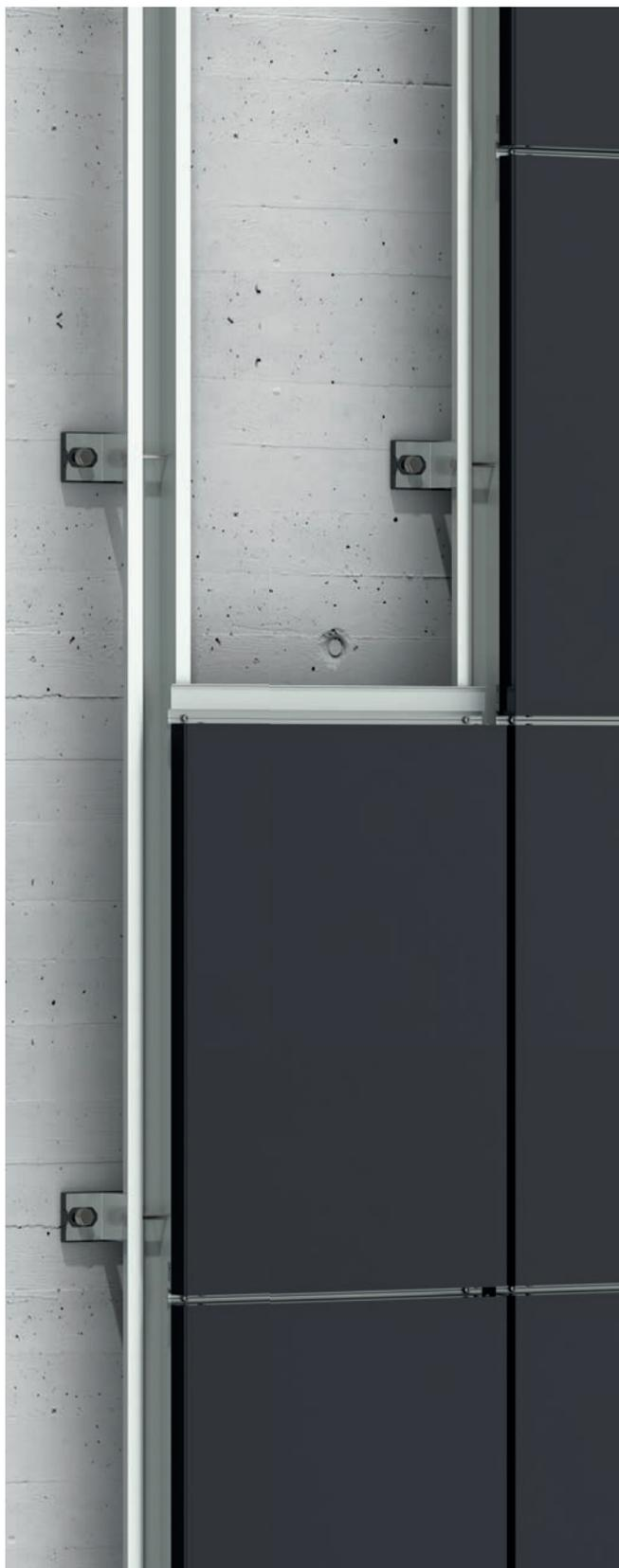
Le STB-SZ est un système kit à base de cassettes issues de **panneau composite STACBOND® pour le montage de bardages**. C'est un système mâle-femelle à fixation non-visible, adaptable et rapide à monter, conçu tout spécialement pour intervenir des bardages à modulation horizontale où prédominent les parties aveugles et/ou peu d'encadrements de baies ou de bavettes linéaires.
