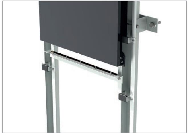
4. Pose d'adhésif et de ruban double face spécifiques sur le profil "L" 30 x 20 mm.
