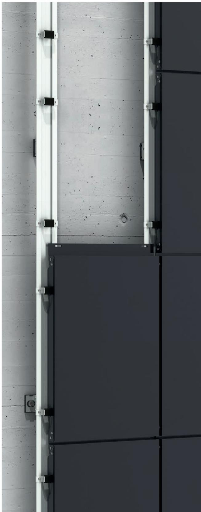
Le **STB-T-CH** est un système kit à base de cassettes suspendues issues de **panneau composite STACBOND® pour le montage de façades ventilées**. C'est un système de fixation non visible, polyvalent et d'installation rapide, dans lequel les modulations des cassettes peuvent se présenter aussi bien dans le sens vertical que horizontal. Le système **STB-T-CH** remplit toutes les conditions requises pour l'exécution des revêtements architecturaux les plus avant-gardistes.
