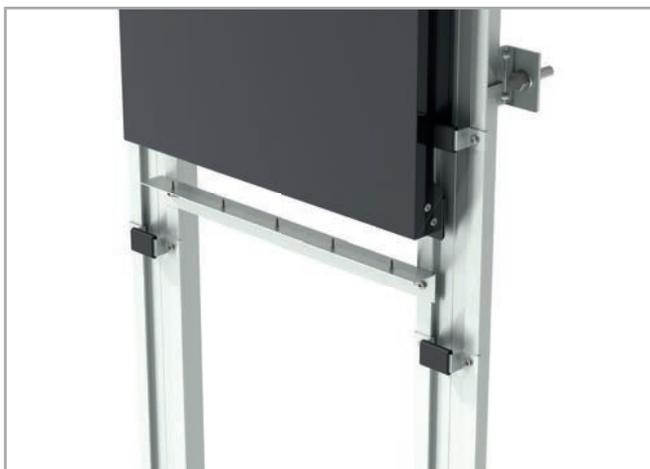
3. Pose de vis 4,2 x 13 DIN 7504 N inox sur profil en "L" de 30 x 20 x 1,3 mm et fixation de ce dernier sur le profil T OMEGA.
