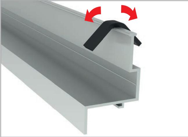
Les segments de joint en EPDM doivent se situer sur la partie supérieure du profil Z et envelopper la tête de ce dernier sur les deux faces. La dimension des segments de joint recommandée est de 60 mm.
