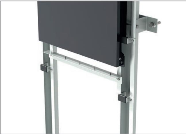
3. Pose de vis 4,2 x 13 DIN 7504 N inox sur profil en "L" de 30 x 20 x 1,3 mm et fixation de ce dernier sur le profil T OMEGA.
