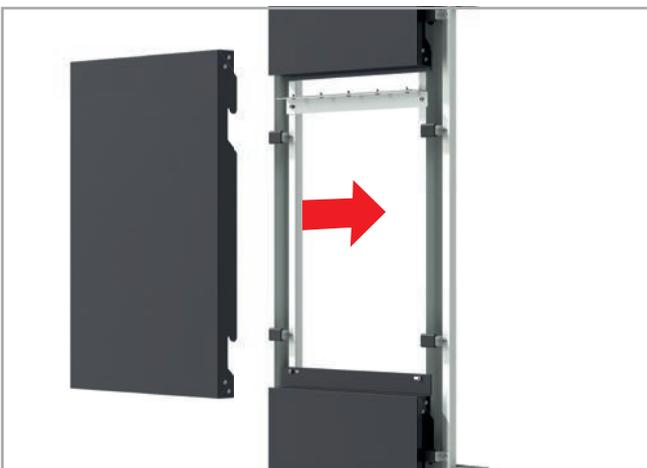
5. Installation de la nouvelle cassette de panneau composite **STACBOND®**, avec pièce de suspension spéciale de 9 mm et pièces de renfort de suspension.
