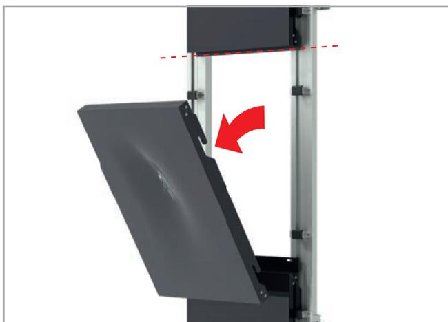
1. Retirer la cassette endommagée en coupant par le rebord supérieur.
