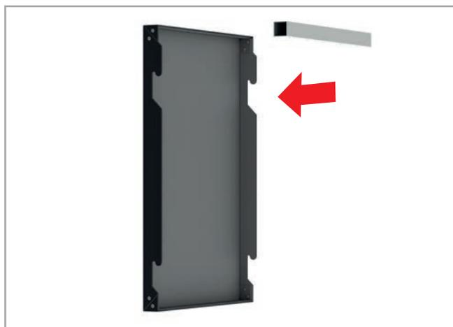
2. Perforer le tube de 30 x 30 x 1,4 mm avec d.6, et mettre en place sur la nouvelle cassette.
