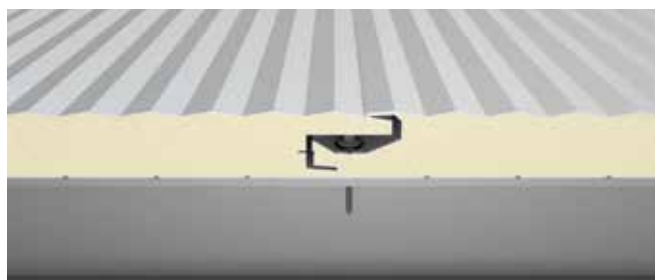
Joint longitudinal avec fixation cachée
