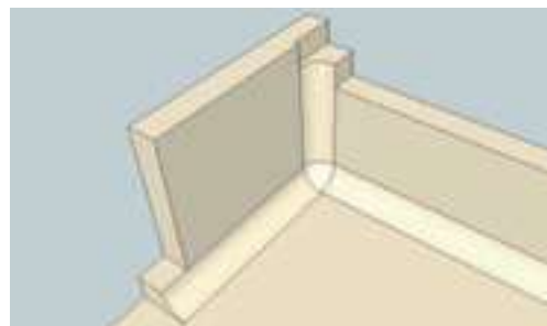
Dossier à congé : détail d'un angle. Réalisé avec défonceuses AK-8G (Albin Kraus) ou FRE317S (Virutex)
