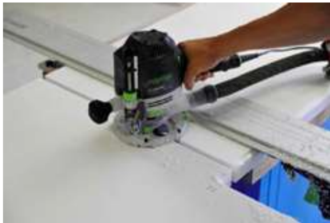
Méthode de défonçage en miroir
