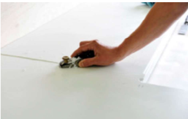
Enlevez l'excédent de colle DuPont™ Corian® à l'aide d'un rabot dont la profondeur de passe est réglée au minimum.
