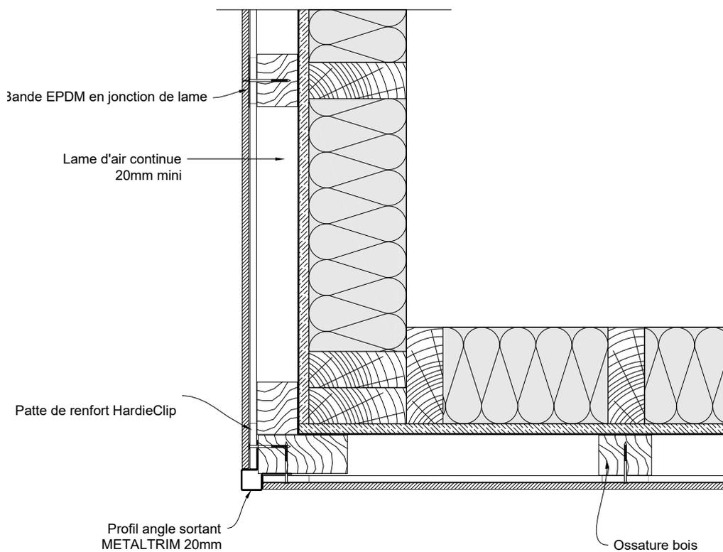
**Figure 24b - Angle rentrant sur COB - Clins horizontaux**
