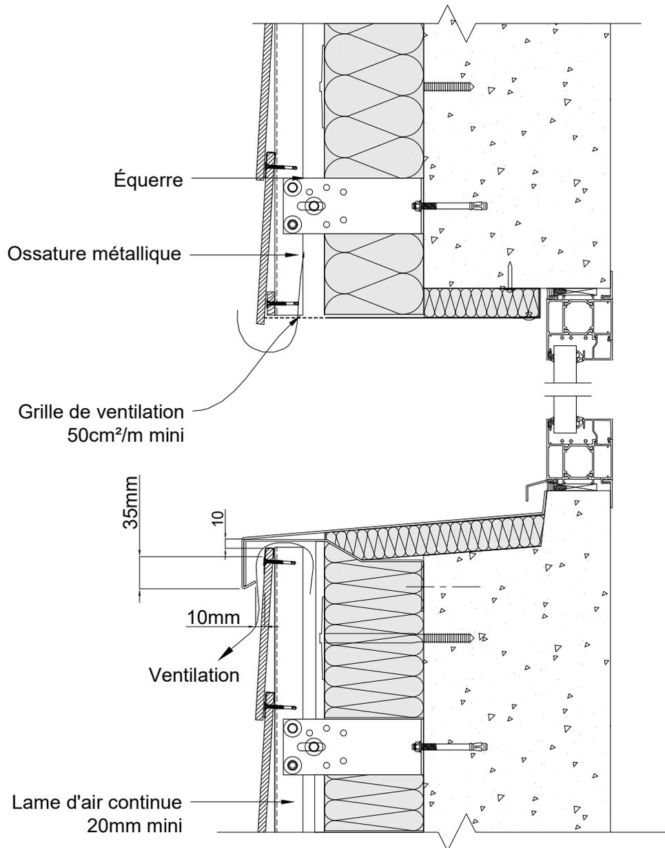
**Figure 21 - Appuis et linteaux sur ossature acier (Coupe verticale)
