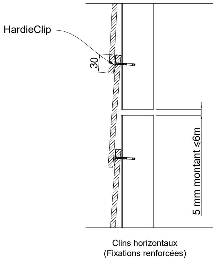
**Figure 17 – Fractionnement d'ossature sur ossature acier - Clins horizontaux**
