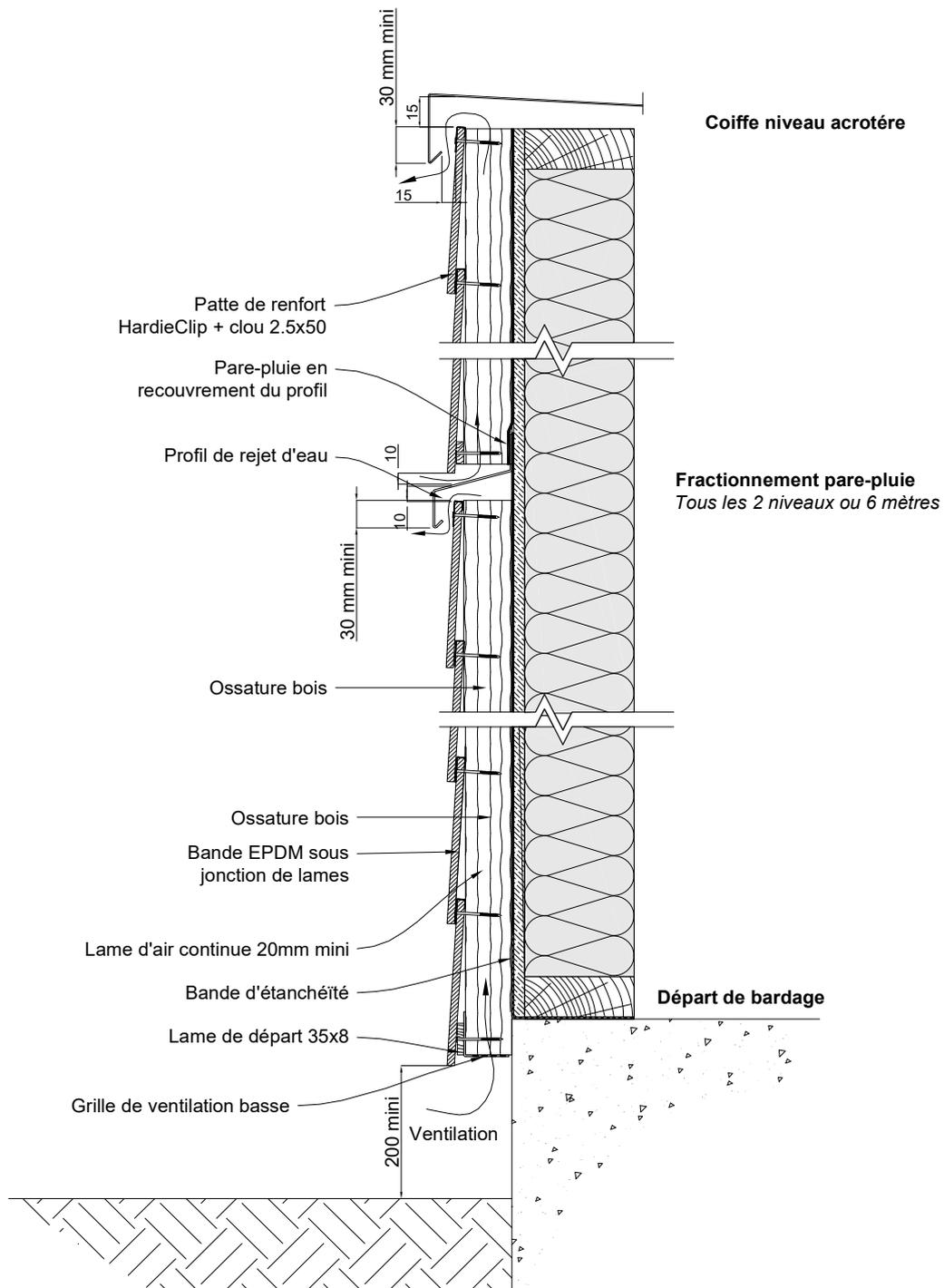
Figure 23 - Départ, Fractionnement de l'ossature, Recouvrement du pare-pluie et Acrotère sur COB (Coupe verticale)
