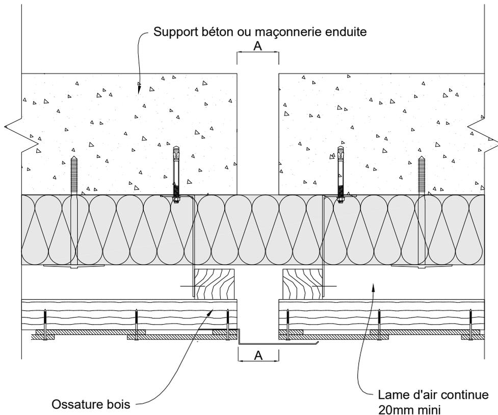
**Figure 8 - Coupe horizontale sur joint de dilatation – ossature bois
