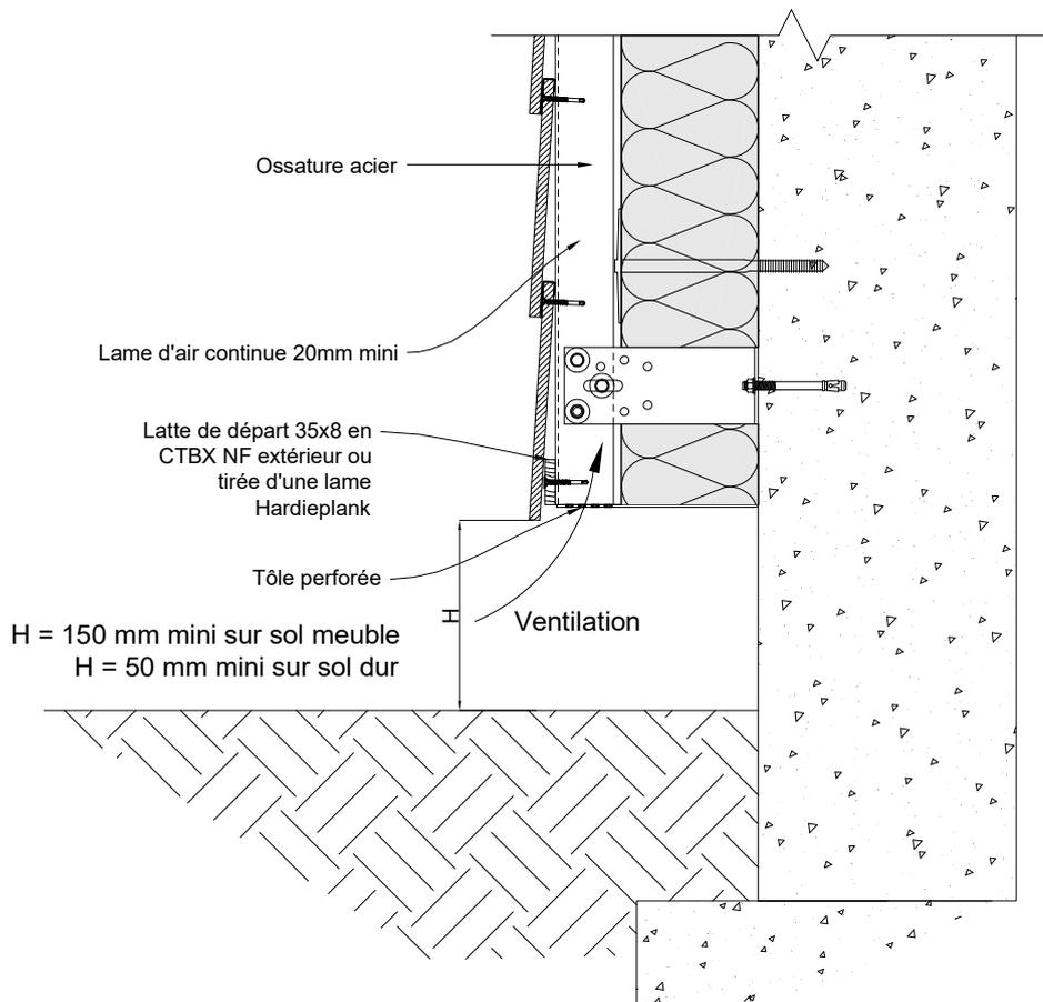
Figure 15b - Départ de bardage sur ossature acier
