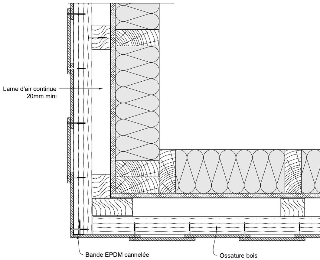
**Figure 25b - Angle sortant sur COB - Clins verticaux**
