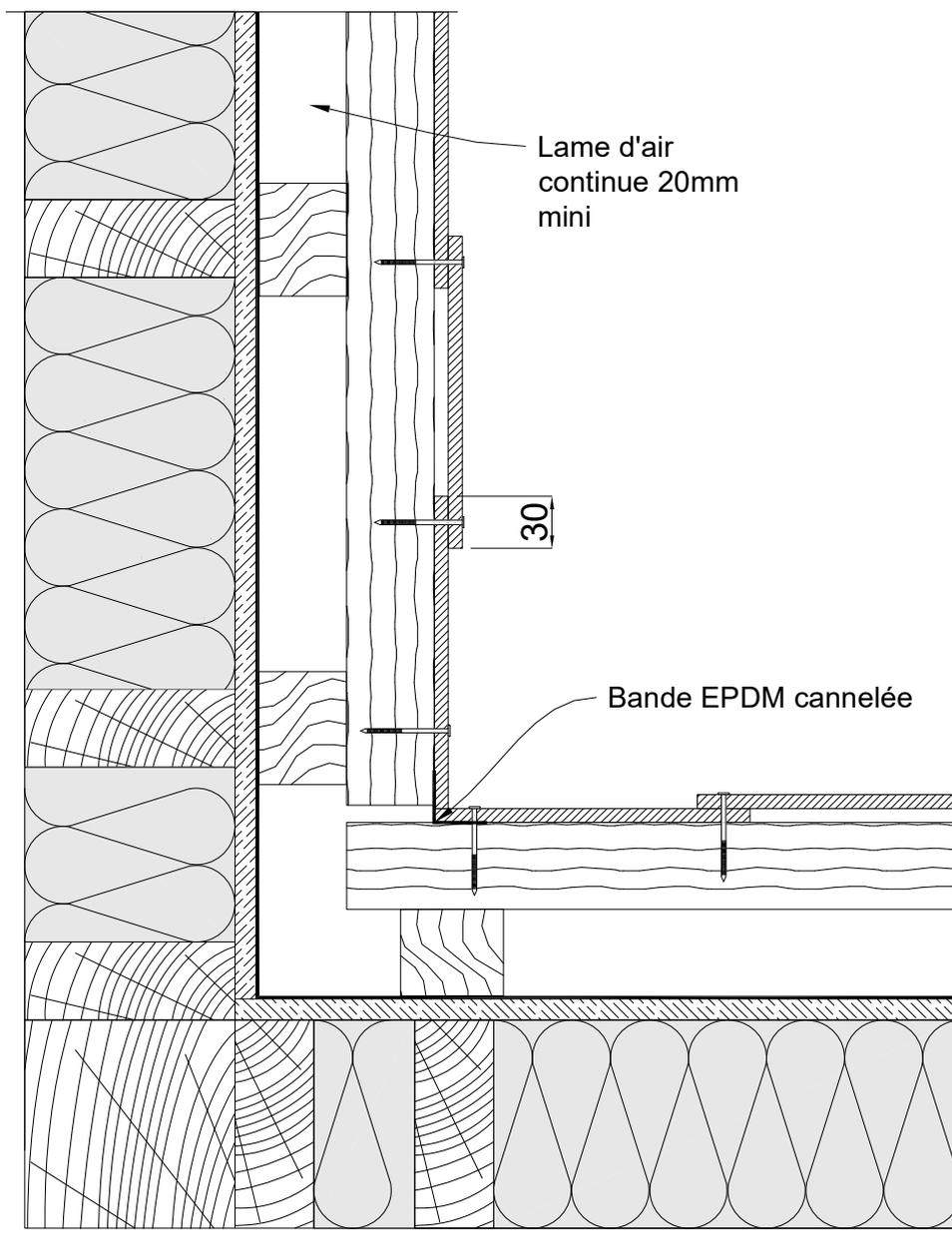
**Figure 25a - Angle rentrant sur COB - Clins verticaux**
