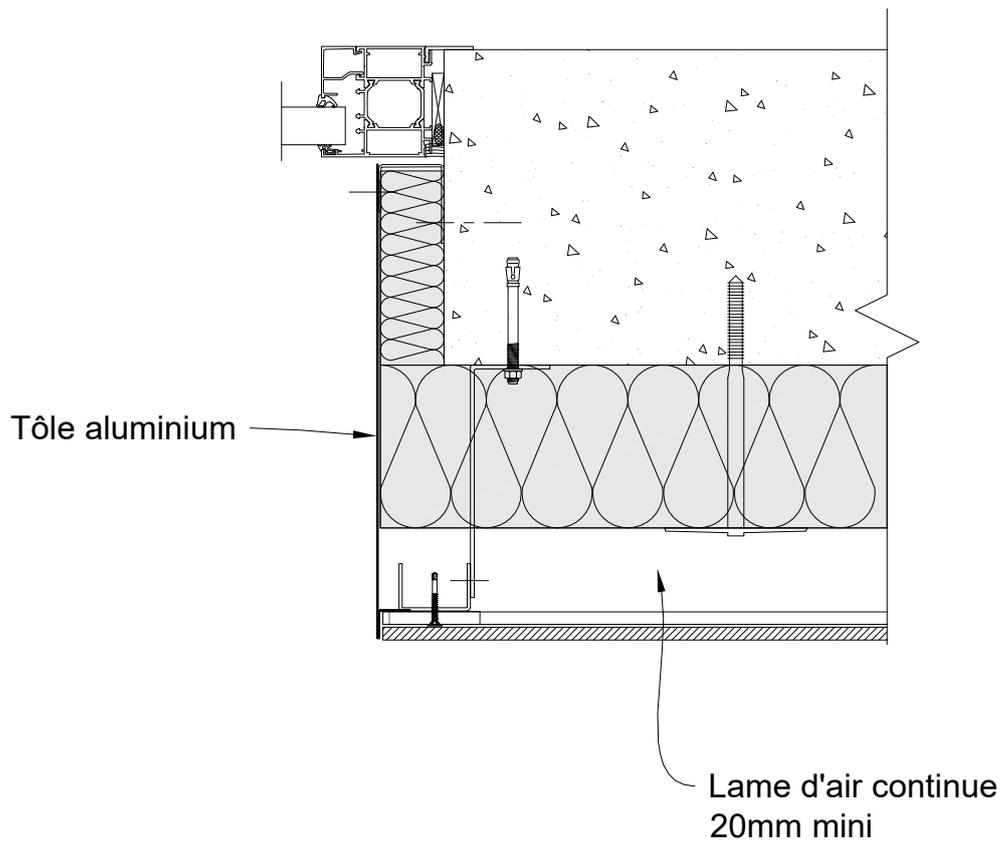
**Figure 22 - Tableau sur ossature acier (Coupe horizontale)
