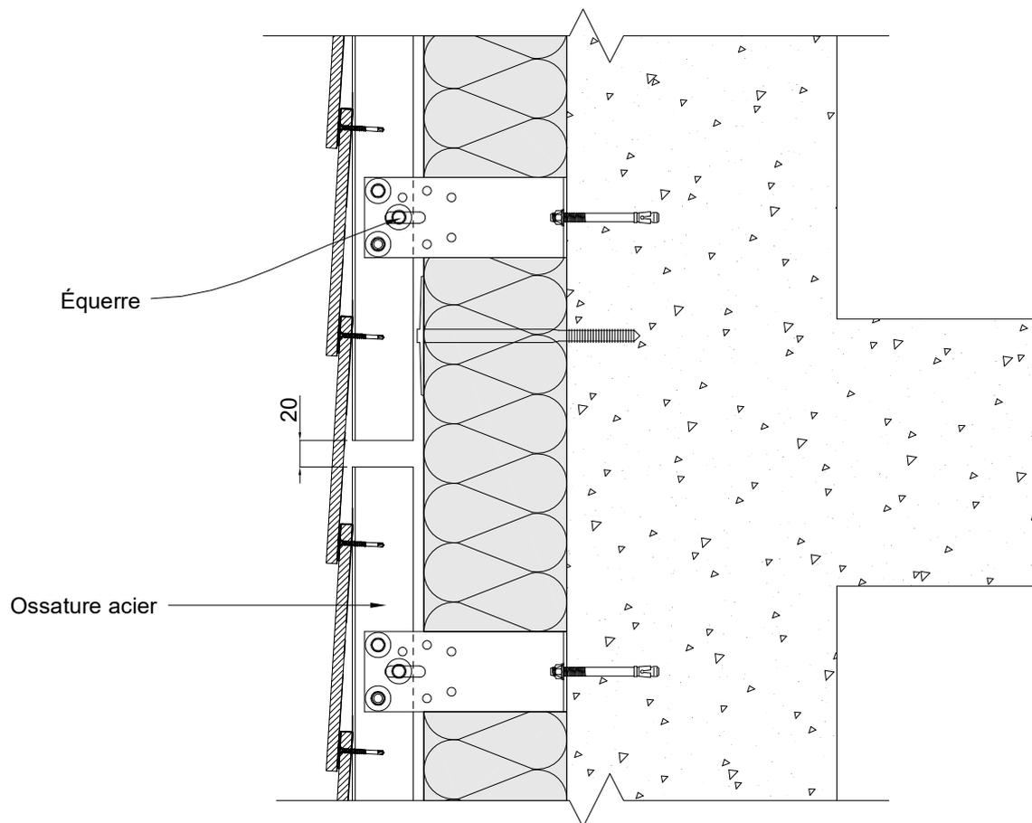
**Figure B2 – Fractionnement au droit de chaque plancher**
