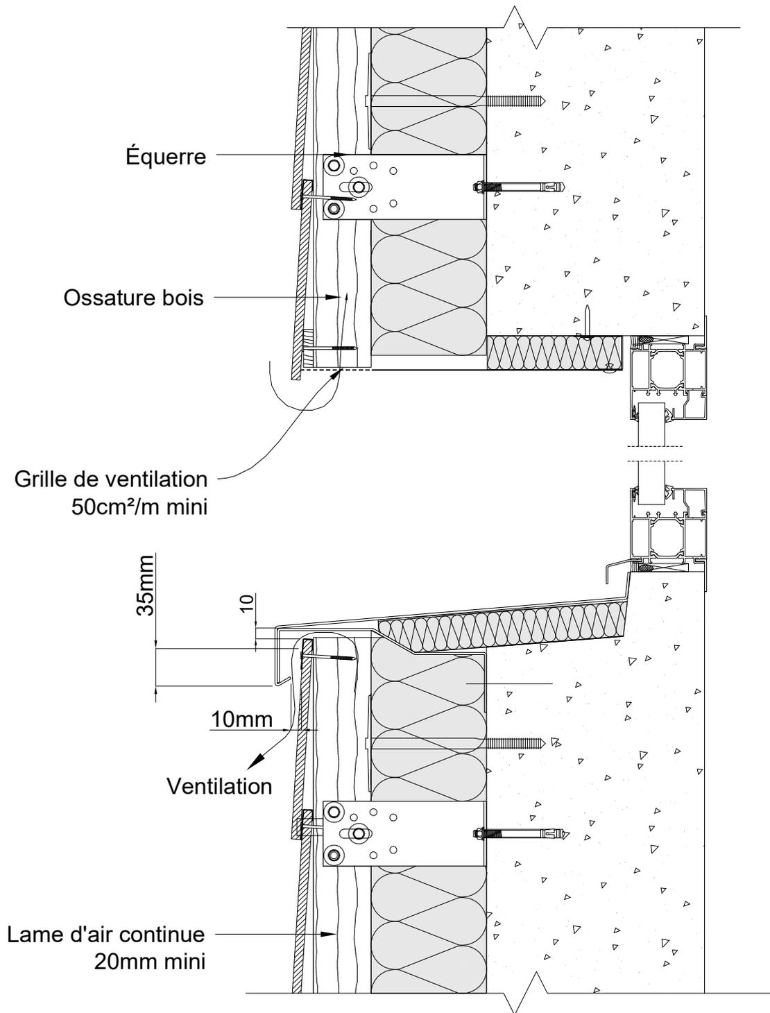
**Figure 11 - Coupe verticale sur appuis et linteaux
