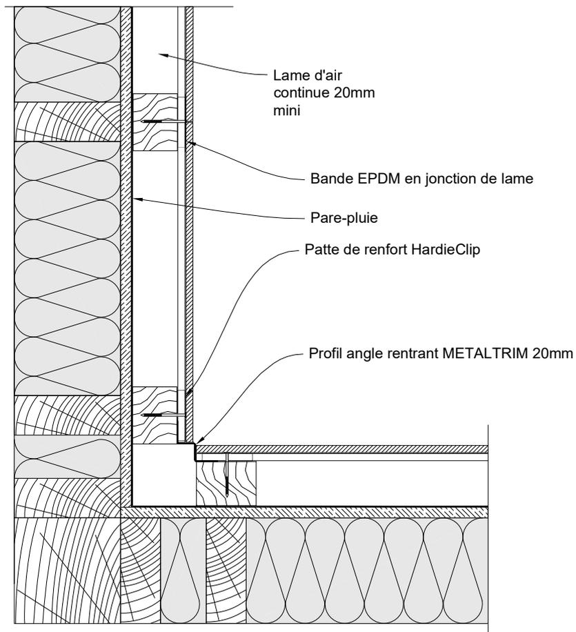
**Figure 24a - Angle rentrant sur COB - Clins horizontaux**
