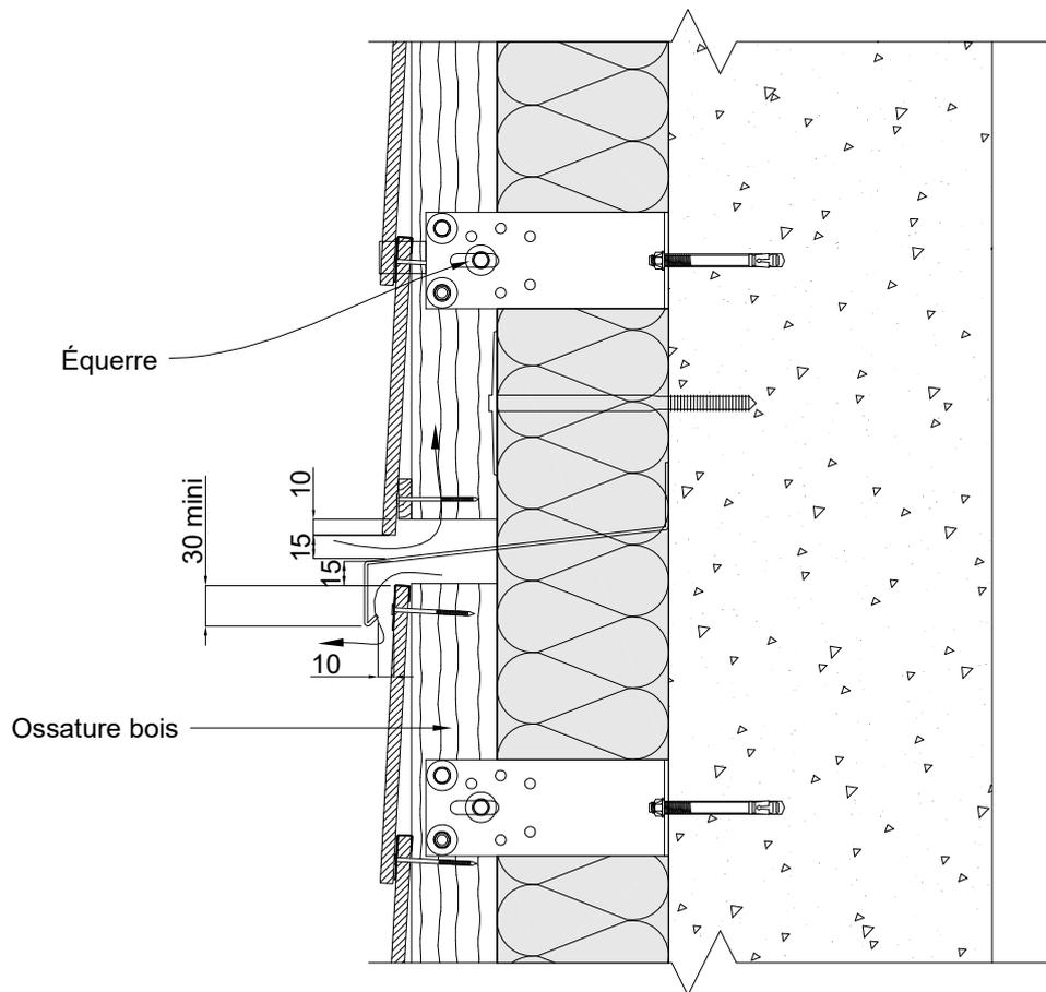
**Figure 3a - Compartimentage lame d'air clins horizontaux – ossature bois**
